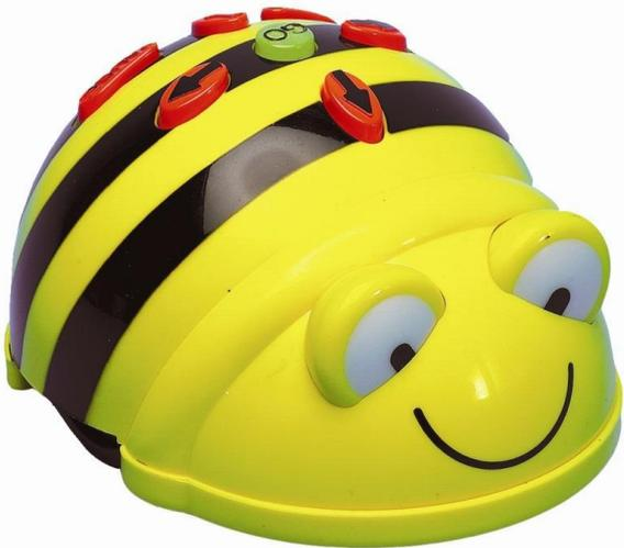
Bee-Bot è un robot a forma di ape. Con i pulsanti presenti sulla schiena è possibile programmare dei percorsi creando strade e mappe per insegnare l'orientamento, la geometria, le distanze. Bee-Bot si muove avanti e indietro (un passo 15 cm) e ruota a destra e a sinistra di 90 gradi.
